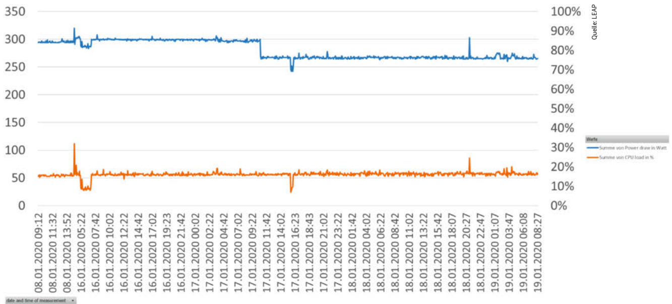
Nach dem Umschalten in den Balance-Modus sinkt die Leistungsaufnahme sofort um etwa 30 Watt (Abb. 3).
