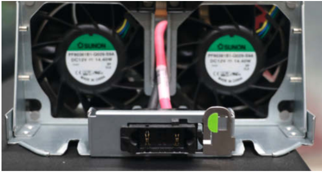
Auf der Rückseite des Tioga Pass befindet sich mittig der Anschluss zur zentralen Gleichstromversorgung, dahinter die beiden 80-mm-Lüfter, die jeweils maximal 14,4 Watt ziehen (Abb. 4).
