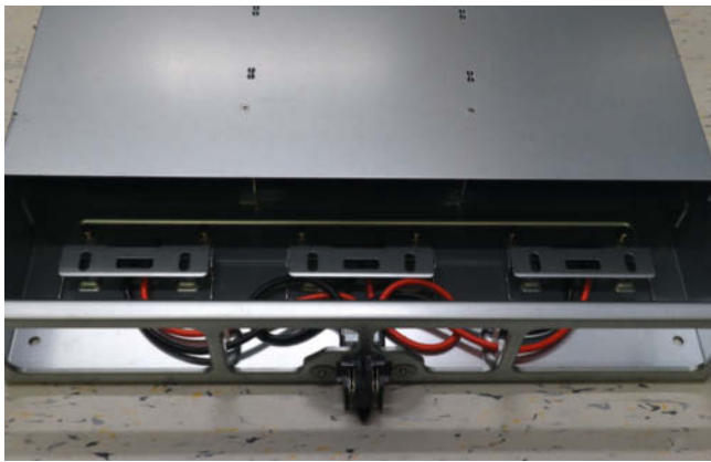
Die leere Schublade bietet Platz für drei Servereinschübe. Die erste Generation des Open Racks nutzt drei Gleichstromschienen, die zweite Generation verwendet eine Unterverteilung von der mittigen Stromschiene auf die drei Einschübe (Abb. 1).
