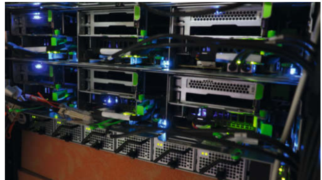
Funktional: Einen ungewohnten Anblick bietet die Vorderseite eines Open Racks. Statt Zierblenden finden sich dort die Anschlusskabel und in der unteren Reihe die zentralen 3000-Watt-Netzteile. Die rötlichen Schaumstoffblöcke ganz unten verhindern einen thermischen Kurzschluss im nicht voll bestückten Rack (Abb. 2).
