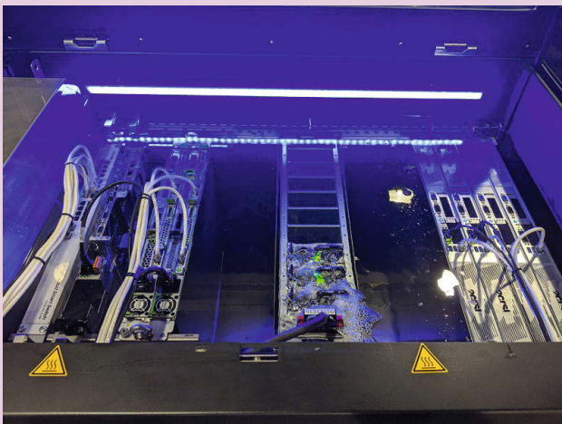
Von oben in den Pod eingetaucht und am Rahmen fixiert werden die Systeme bei der Immersionskühlung. Etwaige mit eingetauchte Lüfter haben dann aber keine Funktion mehr (Abb. 9).
